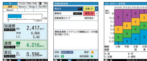
測定画面 故障診断結果画面 ISO 10816-1で規定されたゾーン
