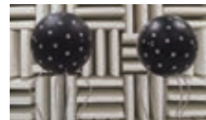
64チャンネル球状マイクロホンアレイシステム
