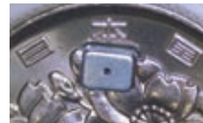
100円玉の上においたMEMSエレクトレットマイクロホン 3.6mm(幅)×2.8mm(高さ)×1.3mm(厚み)
