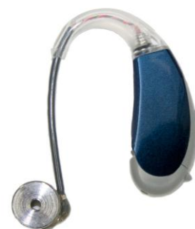
軟骨伝導補聴器 (試作品) ※薬事未承認品です。販売・授与はしていません。
