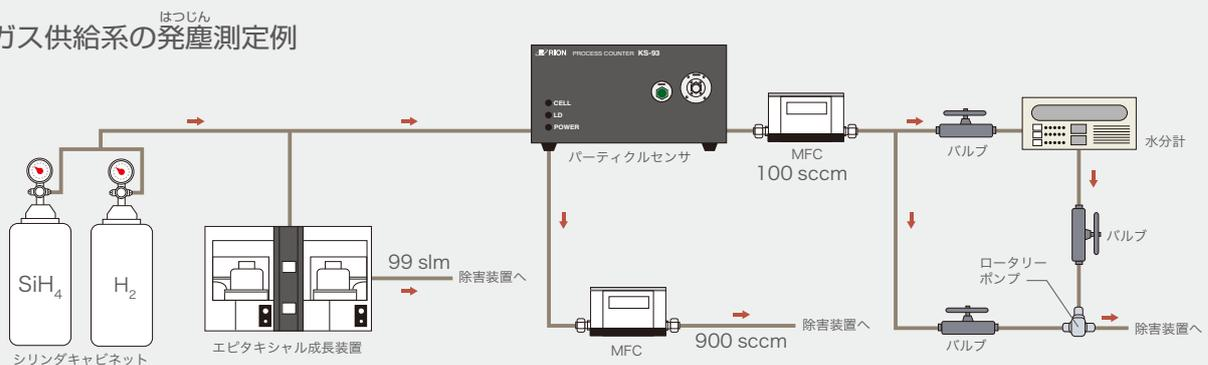
シリンダガスの粒子発塵測定例
