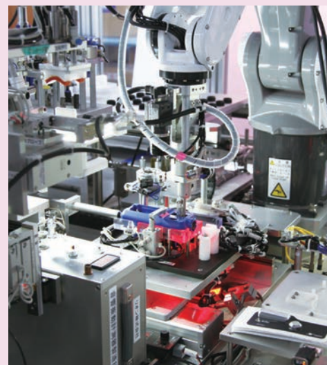
左：VM-63Cを組み立てるロボット 右：入れ替え用のハンド
