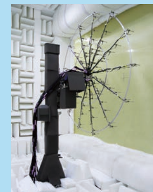
図2 無響測定部を使用した音源探査測定の様子（写真提供：JAXA） 左：マイクロホンアレイ 右：航空機の翼の模型（片翼を90度回転して設置） 左右はアラミド繊維の布で仕切られている
