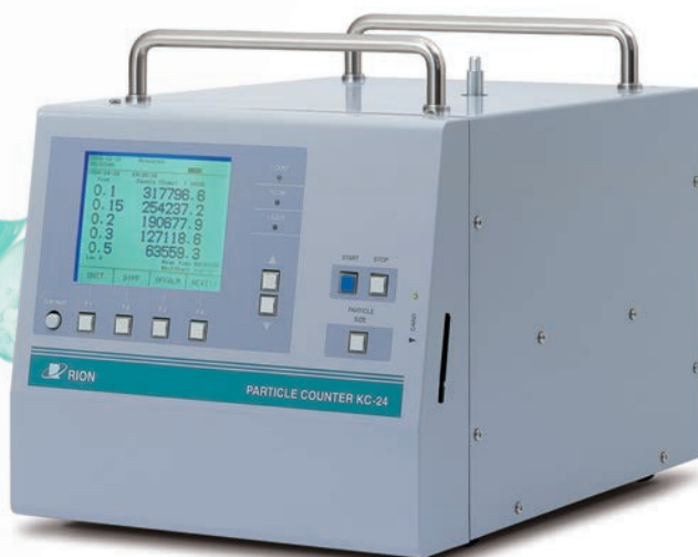
0.1\mu\text{m} の粒子を 28.3\text{L}/\text{min} で測定可能な KC-24 (2004年発売)
